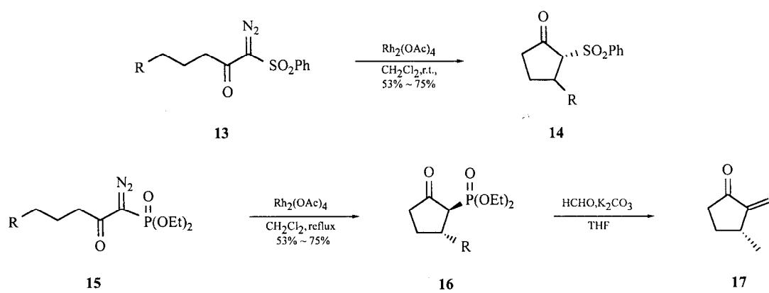
Rh(II)-卡宾还可以对分子内的 X—H ( $X = \text{O}, \text{N}, \text{S}, \text{Si}$  等) 键进行插入, 这类反应可以用于合成酯、内酰胺等化合物<sup>[14~16]</sup>。Merck 公司将 Rh(II)
