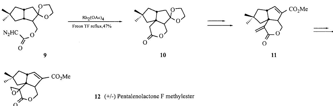
从上面例子我们可以看到, Rh(II) 催化分解  $\alpha$ -重氮酮或  $\alpha$ -重氮- $\beta$ -酮酯化合物的分子内 C—H 插入反应具有很高的区域选择性和立体选择性, 在大多数情况下 C—H 插入生成五元环。在有机反应中形成新的 C—C 键时, 通常碳原子需要被官能团活化, 而在 Rh(II) 催化分解的重氮化合物的 C—H 插入反应中, 可以在没有官能团活化的碳上形成新
